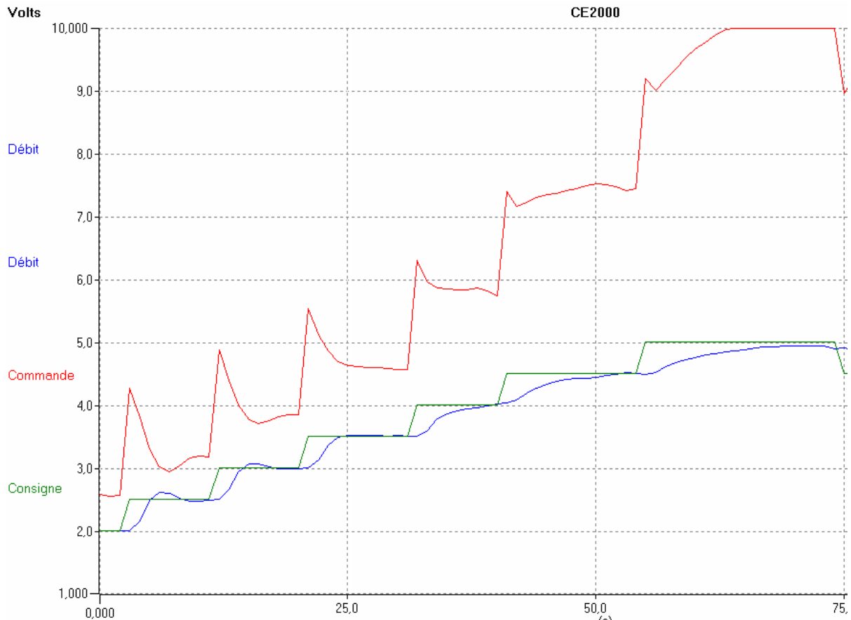
Figure 2.16 : Test en poursuite de la boucle de régulation du débit avec le régulateur Rég_RST. Par pas de 0,5L/min.
